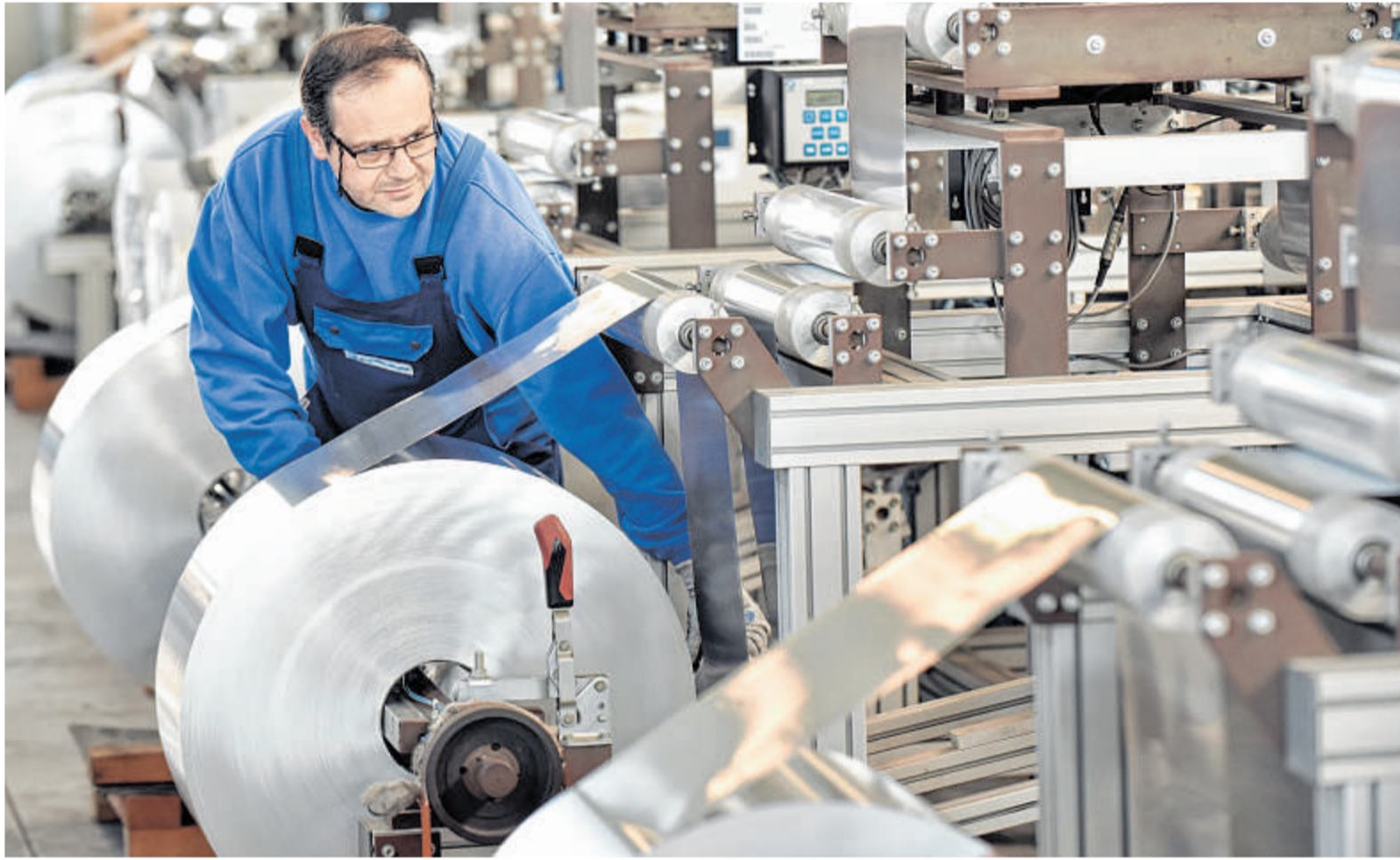
Peter Watras, seit 25 Jahren Maschinenführer bei Klingenburg, an einer Schneide-Präge-Maschine für Plattenwärmetauscher.
