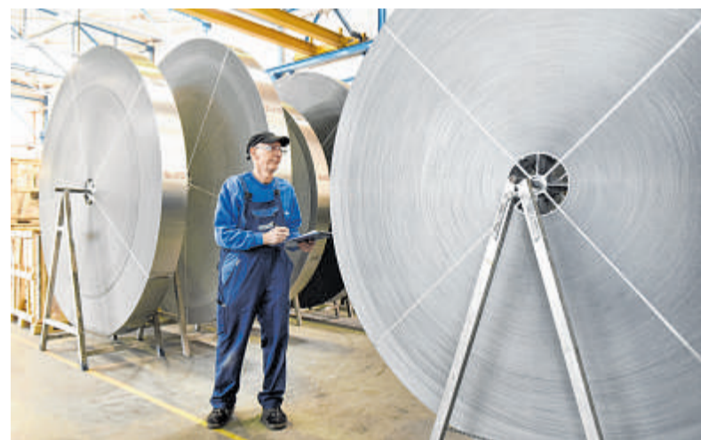
Klingenburg-Mitarbeiter Gerhard Assauer überwacht die Zuordnung der Speichermassen von gefertigten Wärmerädern für die großen Rotations-Wärmetauscher.
