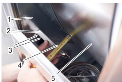
Figura 69: Alineación del sensor con el rotor
