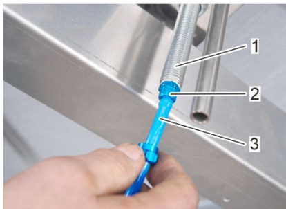
Figura 61: Insertar la manguera de aire comprimido en la boquilla de aire comprimido
