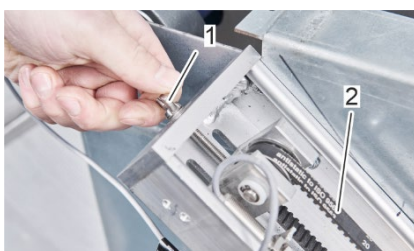
Figura 33: Aflojar la tuerca de mariposa
