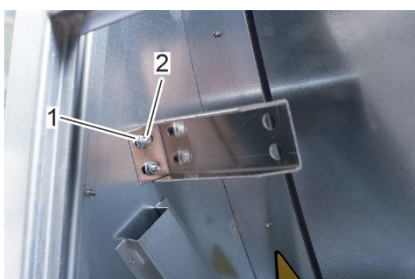
Figura 72: Fijación del soporte del generador de impulsos
