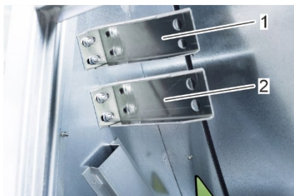
Figura 68: Soportes de los sensores
