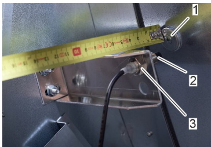
Figura 77: Ajustar el sensor de ciclo
