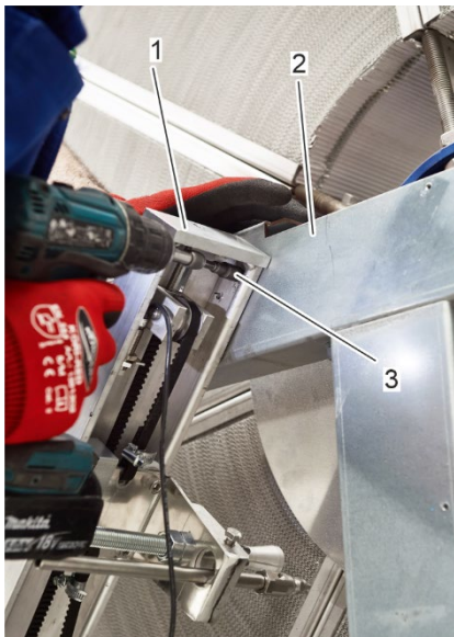
Figura 31: Fijación del riel de limpieza
