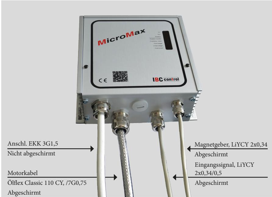
EMV-Verschraubung ist für abgeschirmtes Kabel zu verwenden.
