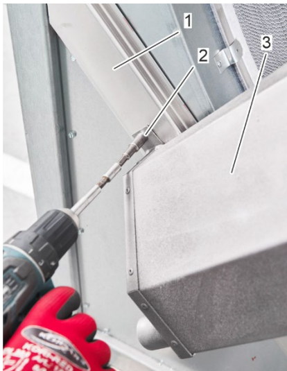
Abbildung 53: Montage der Auffangschale
