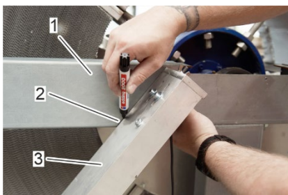
Abbildung 26: Markierung der Position auf der Reinigungsschiene
