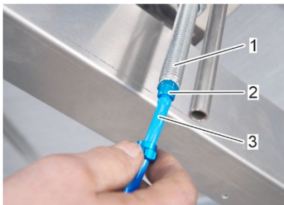
Abbildung 61: Druckluftschlauch in Druckluftdüse schieben
