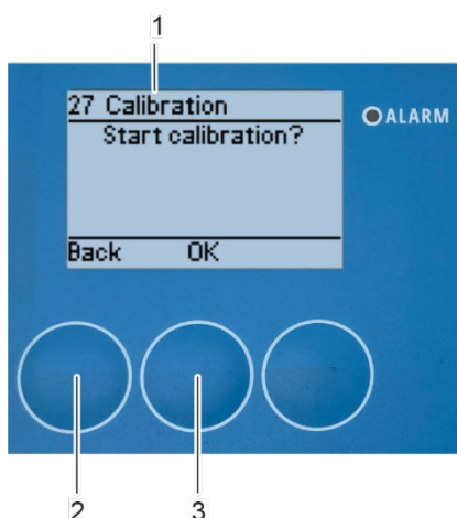
Abbildung 138: Durchführung einer Kalibrierung
