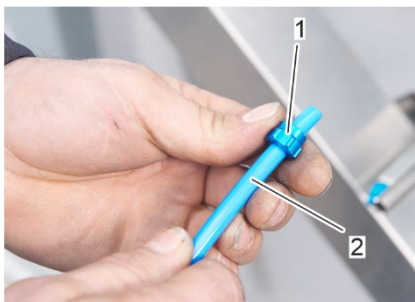
Abbildung 64: Schieben der Überwurfmutter auf das andere Ende des Druckluftschlauches
